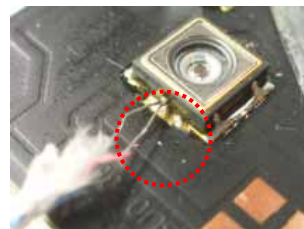
熱電対での Ts 測定には、熱伝導性の高いグリスまたは接着剤をご使用下さい。
